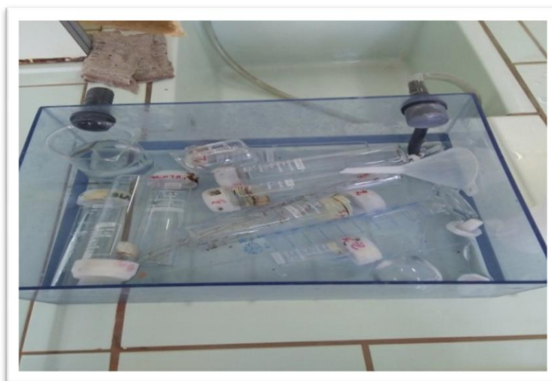
Figure 3: Tube DCO immergé dans l'acide sulfurique.
